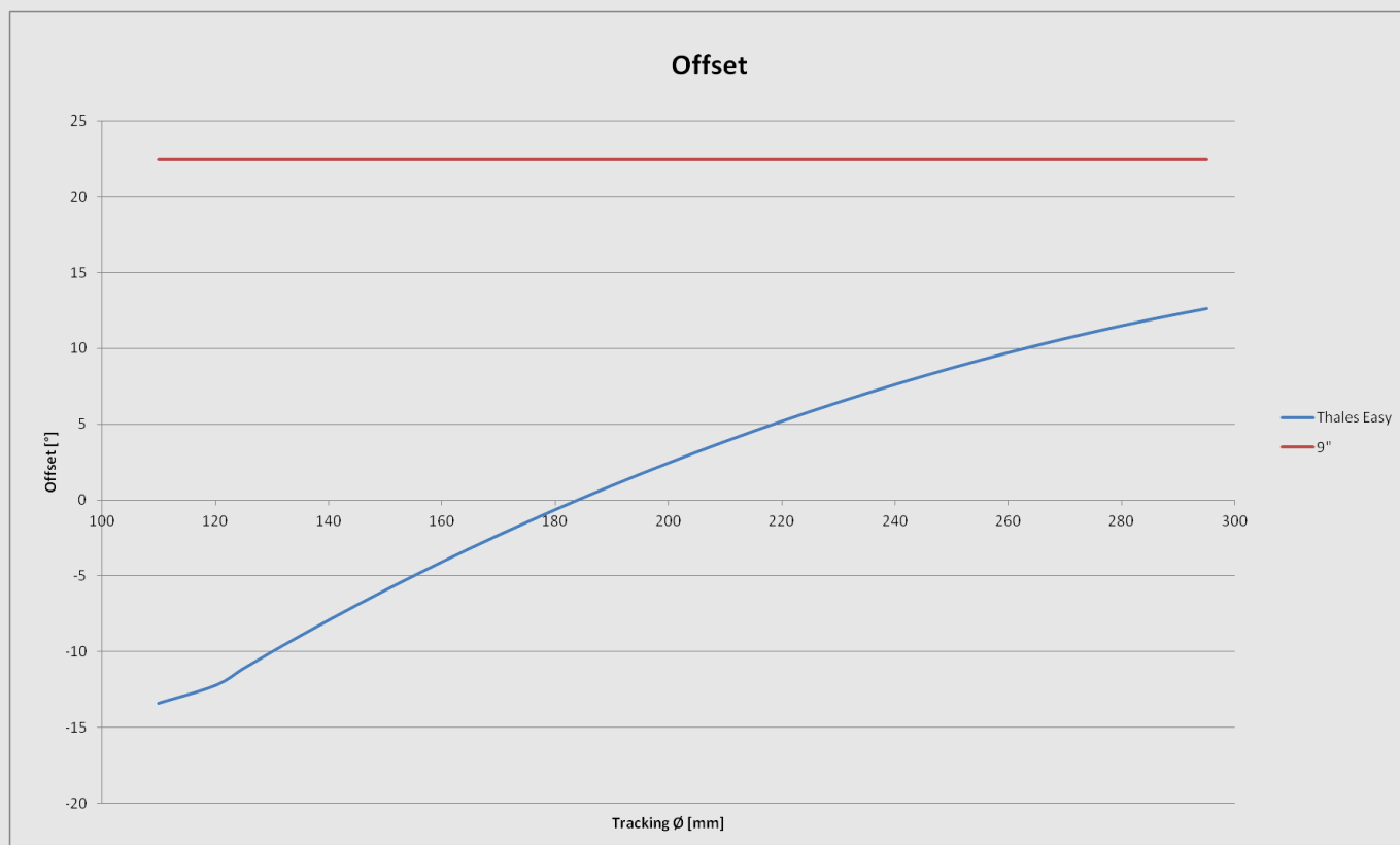
Der variable Kröpfungswinkel vom THALES EASY im Vergleich zur festen Kröpfung beim traditionellen Tonarm
